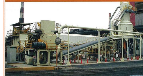
建設系廃木材高炉還元剤リサイクルプラント（SPF250N型）
