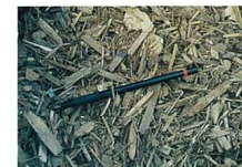
解体材チップ
