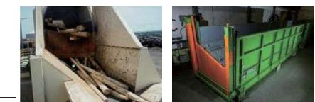
オペレータは、処理材を缶体内に停留させる時間、及び量を調節するために、排出ゲートの高さを調節します。
